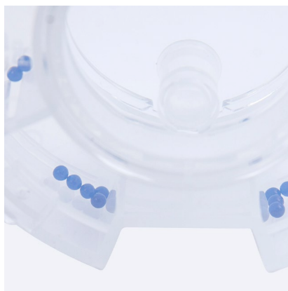
保湿ビーズ機構で長期培養を安定化 乾燥の抑制、環境変化の低減
