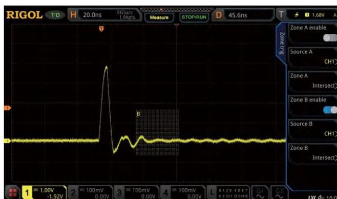
エッジトリガとゾーンAの組み合わせで容易に過渡的な信号でトリガをかけることができます。
