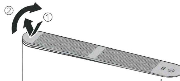
電源スイッチ穴の方向に注意して取り付け、
