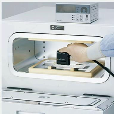
平行平板型については有機物無機物を問わず処理できる汎用性の高いモデルとなっており、その応用例は洗浄だけでなくワーク表面に対して様々な処理を行うことができます。
