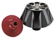
最大容量 312mL 固定角ロータ Type 70 Ti
