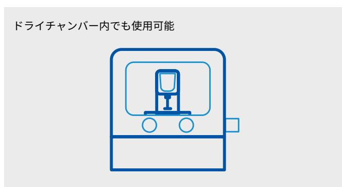
2. ペルチェモジュールを搭載した RSX レオメータは、本体のみで温調が可能ですので、グローブボックス内に設置して粘度測定を行うことができます。
